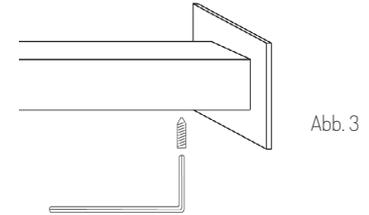
3. Dübel in die Bohrung stecken und Muffe mit den Senkkopfschrauben an die Wand schrauben. Bei einer Rigipsdecke müssen spezielle Dübel verwendet werden. Unser Tipp: Kippdübel eignen sich am besten. (Abb. 1)
